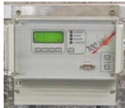
Der Online-Partikelzähler überwacht die Qualität des letzten Spülbades und meldet dem Bediener kritische Veränderungen
