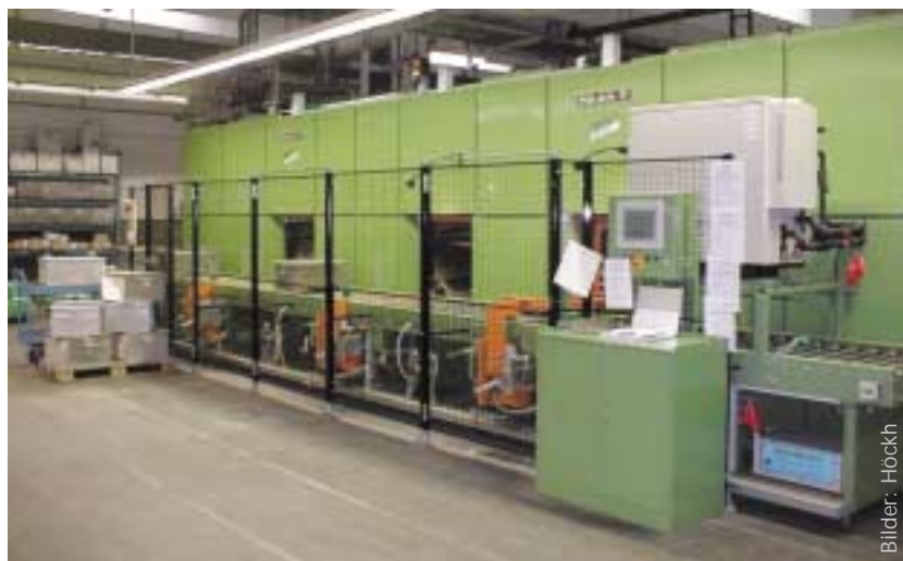
Der maximal 8-stufige Reinigungs- und Trocknungsprozess ist auf insgesamt drei Arbeitskammern aufgeteilt
