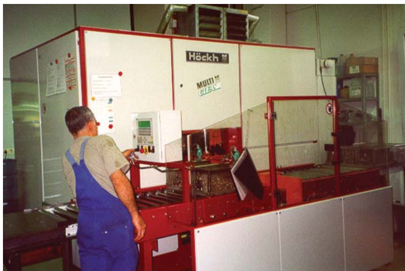
Die Dreherei Böhmler in Pforzheim hat sich für eine Per-Anlage zur Reinigung der Drehteile entschieden und hat damit beste Erfahrungen gemacht
